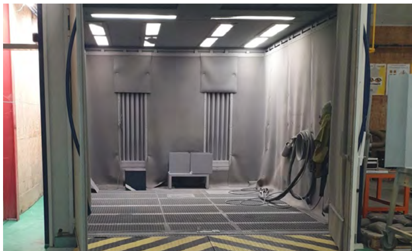
Cabine de grenailage à recyclage automatique
